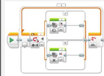
(4) 此程式每當壓下並按住觸碰感應器時便使馬達運行。每當鬆開觸碰感應器時，馬達便停止。此程式使用“觸碰感應器 — 比較 — 觸碰”模式的選擇方塊測試“壓下”。測試的結果用於選擇開啓或關閉馬達。會在迴圈中連續重覆進行測試。
